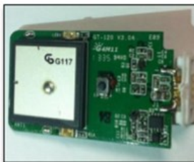
La carte électronique contient la puce GPS, la mémoire de stockage et un étage de gestion de recharge de la batterie.
