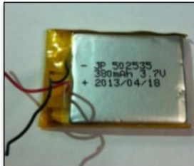
La batterie utilise la technologie Lithium ion et possède une capacité maximale de 380 mAh.
